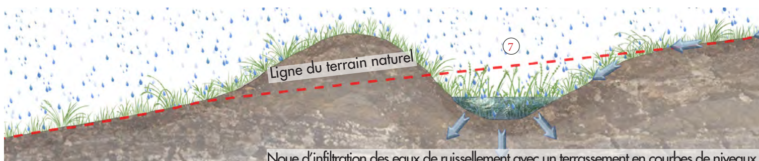
Noue d'infiltration des eaux de ruissellement avec un terrassement en courbes de niveau.
